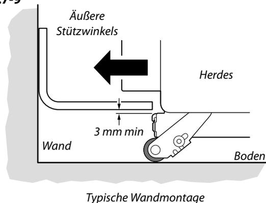
Stellen Sie beim weiteren Vorgehen sicher, dass das Stromkabel und der Gasschlauch immer lang genug sind, um den Herd zu bewegen.
