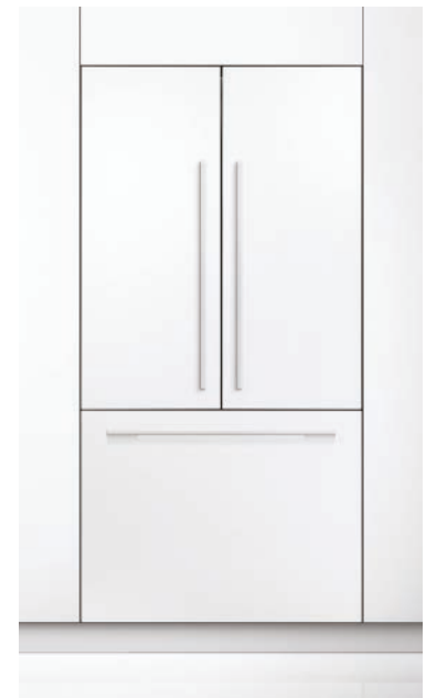
Möbelfront mit durchlaufendem Sockel. Gerät steht auf 10cm Sockel, untere Front ist 10 cm nach unten verlängert und verdeckt die Lüftung. Maße: 190 x 90 / 80 cm
