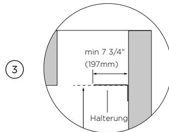
Platzieren Sie die Halterung an der Rückwand. Richten Sie die Unterseite der Halterung entlang der markierten Linie aus.
