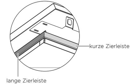
Befestigen Sie den geschälten Teil beginnend an einem Ende des Spurkanzes senkrecht zum oberen Ende der langen Verkleidung.
