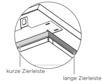
Bringen Sie die kurze Verkleidung für die Länge des oberen Ausschnitts der Türverkleidung weiter an und ziehen Sie dabei die Folie ab.
