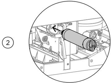
Setzen Sie den Wasserfilter vollständig in das Filtergehäuse ein und drücken Sie fest darauf, bis der Filterkopf weiter in das Gehäuse gedrückt wird.
