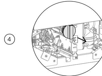
Entfernen Sie das Filterentfernungs Werkzeug vom Wasserfilter und setzen Sie es wieder auf das obere Gitter.
