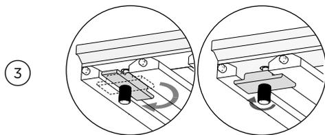
Drehen Sie den Halteblock in die Verriegelungsposition und ziehen Sie die Schraube fest, um den Griff zu verriegeln.
