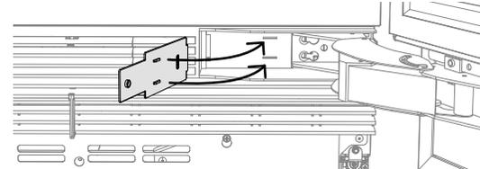
Setzen Sie die Abdeckung der Scharnierabdeckungen in die Scharnierabdeckungen ein und passen Sie die Stifte an der Abdeckung an die Schlitz in der Scharnierabdeckungen an.
