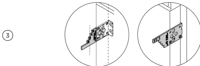
Überprüfen Sie die Tiefenmesser, während Sie die Schrauben einstellen, um die Ausrichtung des Geräts aufrechtzuerhalten.
