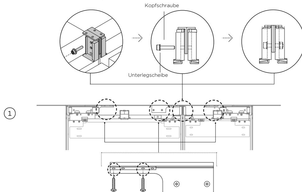
Befestigen Sie die oberen Kappen beider Geräte mit der Kopfschraube M5x20 und der Unterlegscheibe am zentralen Abstandshalter.
