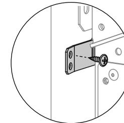
Befestigen Sie eine untere Seitenhalterung mit 8Gx16-Senkschrauben an der Schrankseite.
