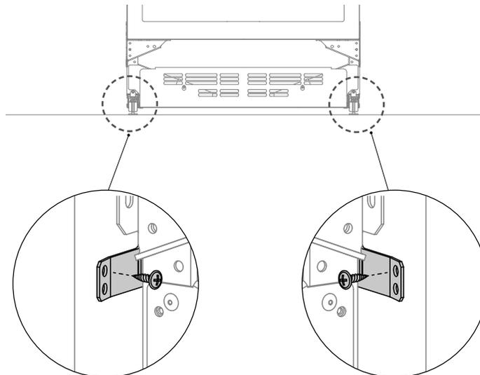
Befestigen Sie die seitlichen Halterungen (2x) mit 8Gx16-Senkschrauben an der unteren rechten und linken Seite des Gehäuses.
