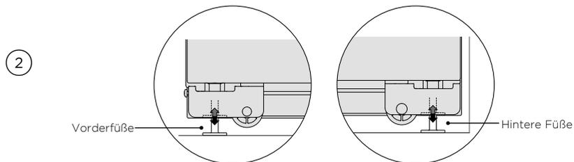
Drehen Sie die vorderen und hinteren Einstellschrauben im Uhrzeigersinn, um die vorderen und hinteren Füße zu verlängern, bis sie am Boden anliegen und die obere Halterung die Schrankdecke erreicht.
