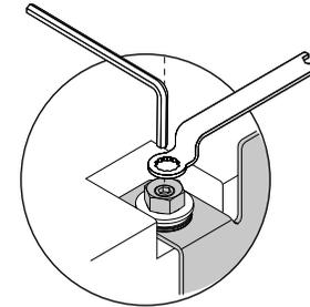
Schrauben Sie die M8-Unterlegscheibe und die Mutter an die Einstellschraube und ziehen Sie sie locker an.
