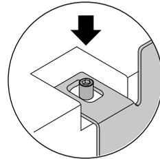
Halten Sie die Türverkleidung in einem Winkel von der Oberseite der Tür und senken Sie die Schraubenlöcher der Aufhängevorrichtung auf die Einstellschrauben. .
