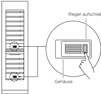
Öffnen Sie den Deckel des Filtergehäuses, indem Sie auf die Verriegelung drücken.
