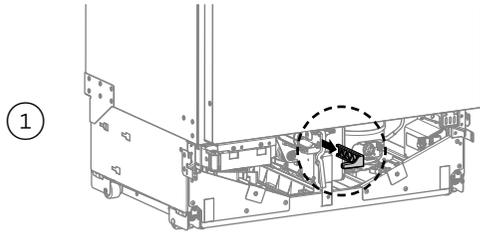
Halten Sie die Tür geschlossen und stellen Sie sicher, dass das Gerät stabil ist, bevor Sie den Wasserfilter installieren, um das Risiko eines Umklippens des Geräts zu vermeiden.
