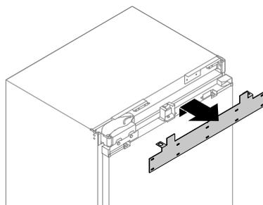
Entfernen Sie die Aufhängevorrichtung und legen Sie sie zur späteren Verwendung beiseite.
