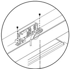
Entfernen Sie die # 8x16-Schrauben (2x) vom Sensorgehäuse.
