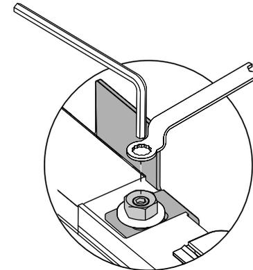
Um die Türverkleidung weiter einzustellen, entfernen Sie die Türverkleidung, lösen Sie die Befestigungsschrauben der hängenden Halterung und bewegen Sie die Halterung entsprechend zur Seite.
