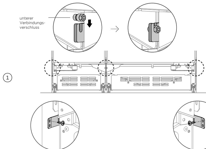
Befestigen Sie die unteren Verbindungshalterungen beider Geräte zusammen mit dem unteren Halterungsverchluss.
