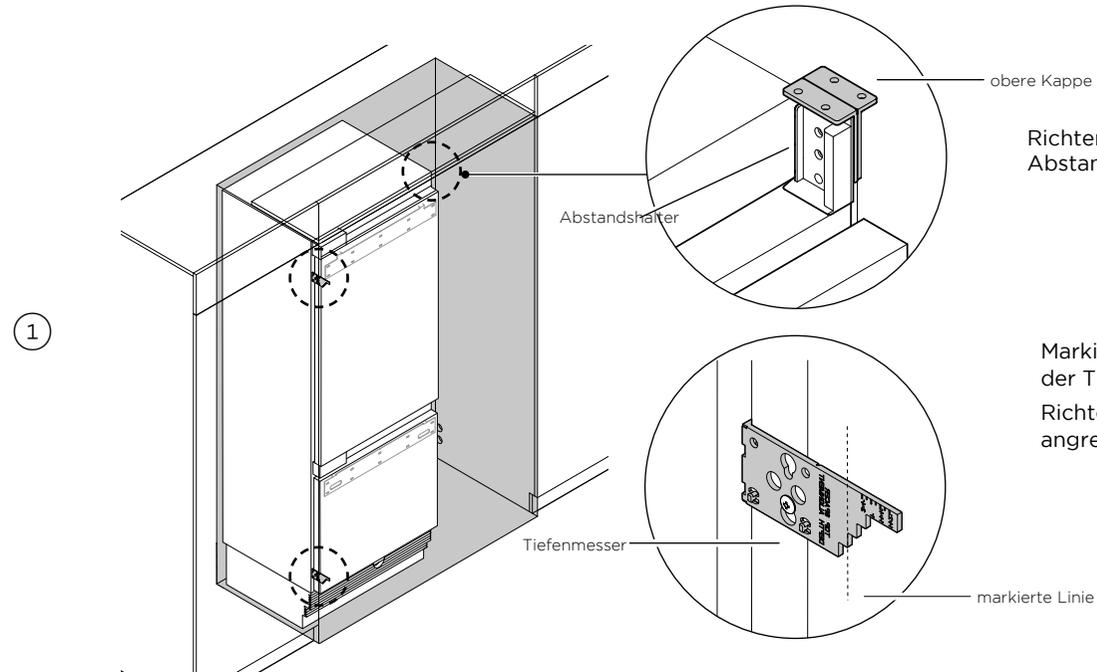
Richten Sie die obere Kappe des ersten Geräts bündig mit der Vorderseite des Abstandshalters aus.
