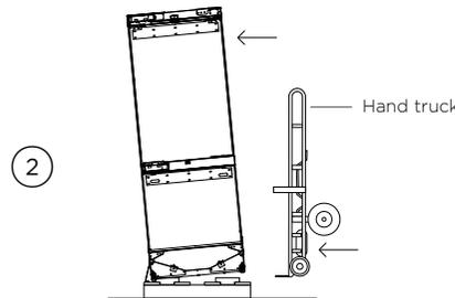
Kippen Sie das Gerät leicht nach vorne und setzen Sie den Handwagen zwischen Palette und Gerät ein.
