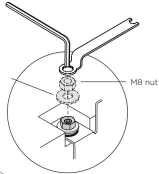
Entfernen Sie die M8-Mutter und die M8-Unterlegscheibe von der M8-Schraube oben an der Tür mit dem mitgelieferten Inbusschlüssel und Schraubenschlüssel.
