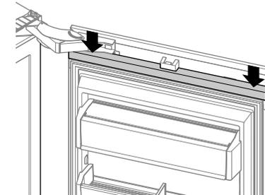
Drücken Sie beide Enden der oberen Abdeckung nach unten, um die Verkleidungskappen an den Klebestreifen zu aktivieren.
