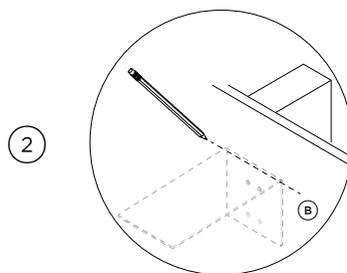
Markieren Sie eine horizontale Linie (B) an der Rückwand.
