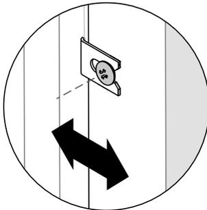
Lösen Sie die seitlichen Schrauben an den seitlichen Halterungen und schieben Sie die Türverkleidung nach vorne / hinten. Sobald Sie zufrieden sind, wieder festziehen.
