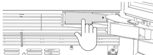
Drücken Sie auf die Abdeckung, um sicherzustellen, dass die Abdeckung passt.
