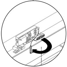
Lösen Sie den Hallsensor vom Gehäuse.
