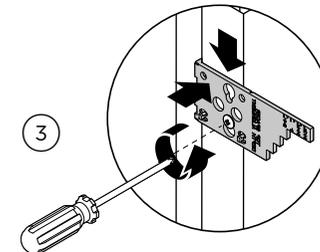
Setzen Sie das Ausrichtungsmessgerät ein, indem Sie den Schraubenkopf durch das Schlüsselloch des Messgeräts stecken.
