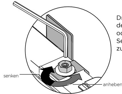
Drehen Sie die Einstellschraube, um die Höhe der Türverkleidung relativ zur Tür anzuheben oder abzusenken. Setzen Sie die Einstellung fort, bis der Abstand zum Gehäuse mehr als 3 mm beträgt.
