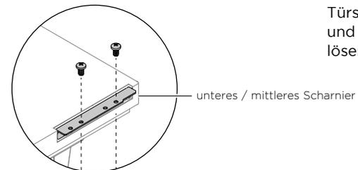
Lösen Sie die Tür vom Gerät, indem Sie die Sechskantschrauben (4x) des Türscharniers M6x10 am oberen Scharnier und am unteren / mittleren Scharnier lösen.
