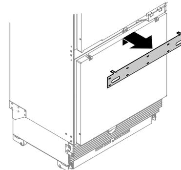
**Für Kühl- / Gefrierschrank:** Wiederholen Sie die Schritte 1 bis 3, um die Halterung der Schublade zu entfernen. Lösen Sie die M8-Mutter mit einem Steckschlüssel.
