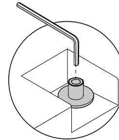
Lösen Sie die M8-Schrauben um 3 mm.
