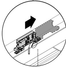
Bewegen Sie das Sensorgehäuse, um den gegenüberliegenden Hallsensorclip mit der Mitte des Gehäuses auszurichten.
