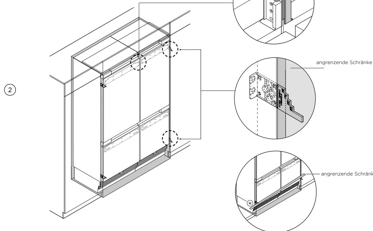
Richten Sie die obere Kappe des zweiten Geräts bündig mit dem zentralen Abstandshalter und der oberen Kappe des ersten Geräts aus.
