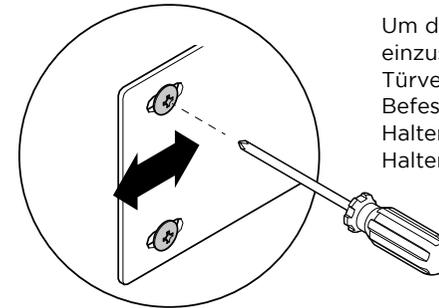
Um die Türverkleidung weiter einzustellen, entfernen Sie die Türverkleidung, lösen Sie die Befestigungsschrauben der hängenden Halterung und bewegen Sie die Halterung entsprechend zur Seite.
