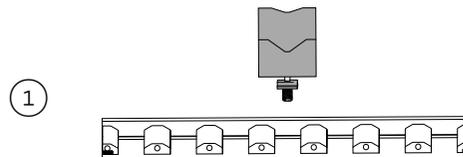
Setzen Sie den Halteblock an der gewünschten Stelle zwischen den Lamellen des Display-Racks ein. Nicht festziehen.
