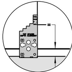
Markieren Sie auf der Seite „Tiefe des oberen Abstandshalters“ des Tiefenmessgeräts die Befestigungsposition des zentralen Abstandshalters auf dem Gehäuse.
