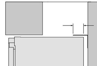
Stellen Sie beim Einrollen des Geräts in den Schrank sicher, dass die Kippschutzhalterung die Hinterkante des Geräts überlappt.
