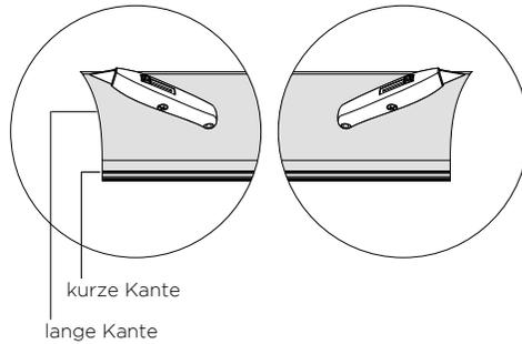
Schneiden Sie beide Enden der kurzen Verkleidung ab. Ziehen Sie eine kleine Portion roten Schutzfilms von der kurzen Kante ab.
