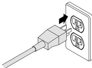
Schließen Sie den Netzstecker an der Rückseite Ihres Geräts an die Steckdose an (115 VAC, 60 Hz).
