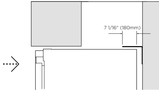
Rollen Sie das Gerät vorsichtig in den Schrank, bis die Anti-Kipp-Halterung die Hinterkante des Geräts überlappt.
