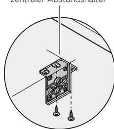
Befestigen Sie den zentralen Abstandshalter mit zwei Senkschrauben 8Gx16 an der Nischendecke.
