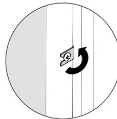
Richten Sie die Türverkleidung gerade an der Tür aus und schieben Sie die Seitenhalterungen an den Seitenschrauben der Tür ein. Ziehen Sie die Seitenschrauben locker an, um die Türverkleidung vorübergehend zu sichern.
