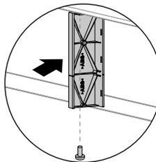
Drücken Sie den Strömungsteiler fest gegen die Unterseite der Tür- / Schubladenverkleidung. Stellen Sie sicher, dass die Klebeschichtseite des Teilers die Türverkleidung berührt. Befestigen Sie den Luftstromteiler mit einer Schraube an der Platte.
