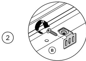
Befestigen Sie die Verriegelungshalterung mit einer Senkschraube 8Gx16 an der Türverkleidung.
