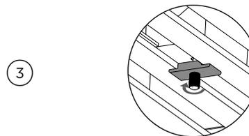
Drehen Sie den Halteblock in die Verriegelungsposition und ziehen Sie die Schraube fest. Entfernen Sie die Halterungsführung nach Gebrauch vom Rack.
