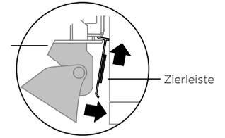
Positionieren Sie die Verkleidung in einem Winkel am Hals des Türscharniers.
