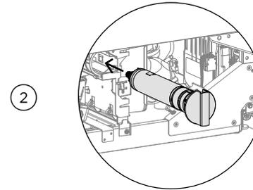
Halten Sie den Wasserfilter mit dem Filterentfernungs Werkzeug so, dass der Griff vertikal positioniert ist, und setzen Sie ihn in das Gehäuse ein, bis der Filterkopf vollständig in das Gehäuse gedrückt ist.
