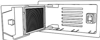
Schieben Sie den Filter vorsichtig in die Luke, bis er bündig ist, und schließen Sie dann die Abdeckung, bis sie am Riegel einrastet.
