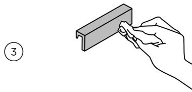
Wischen Sie die Etiketten zum Löschen mit einem feuchten Tuch ab.
