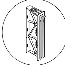
Entfernen Sie die Klebeschicht vom Luftstromteiler.
