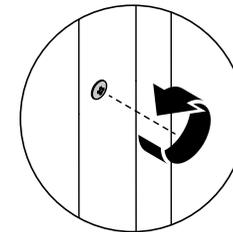
Lösen Sie die rechte und linke Schraube an der Ober- und Unterseite der Tür. (A) Suchen Sie die Ausrichtungsmesser in der richtigen Ausrichtung zu den rechten und linken Schrauben.
