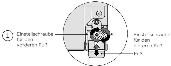
Durch Drehen der vorderen und hinteren Einstellschrauben im Uhrzeigersinn wird die Höhe des Geräts erhöht.
