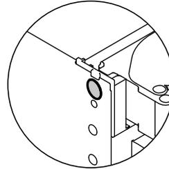
Führen Sie vor dem Einrollen in den Hohlraum einen Stacheldraht in die großen Löcher oben rechts und links am Gerät ein.
