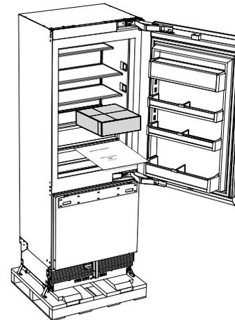
Entfernen Sie das Installationskit und das Kit für verschiedene Gegenstände aus dem Inneren des Geräts.
