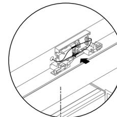
Drücken Sie den Kabelbaum von der Abfangplatine in die Gabeln am Sensorgehäuse.
