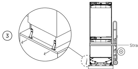
Halten Sie das Gerät mit einem Gurt fest und entfernen Sie die restlichen Halterungen.
