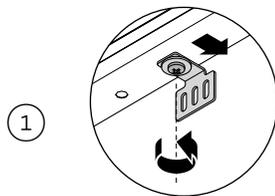
Lösen Sie die Schraube unten an der Tür und schieben Sie die Verriegelungshalterung heraus, bis sie die Verkleidung berührt.
