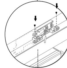
Bringen Sie das Sensorgehäuse mit den Schrauben Nr. 8x16 (2x) wieder in den vorgebohrten Löchern in der Schrankoberseite an. Den Hallsensor einclippen
