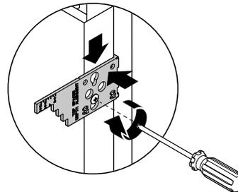
Lösen Sie die rechte und linke Schraube an der Ober- und Unterseite der Tür.
