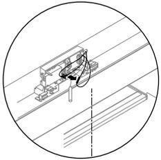
Den Kabelbaum der Abfangplatine vom Sensorgehäuse aushängen, damit der Kabelbaum locker ist.
