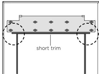
Platzieren Sie die kurze Verkleidung entlang der Länge der Oberseite des Türverkleidungsausschnitts über den oberen Enden der langen Verkleidungen. **(A)**
