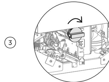
Drücken Sie fest, bis der Wasserfilter vollständig in das Gehäuse eingedrungen ist. Drehen Sie das Filterentfernungs Werkzeug im Uhrzeigersinn, um den Wasserfilter zu arretieren.
