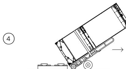
Kippen Sie nach hinten, um das Gerät auf den Handwagen zu laden, und legen Sie die Palette beiseite. Schieben Sie den Handwagen zum Installationsort.
