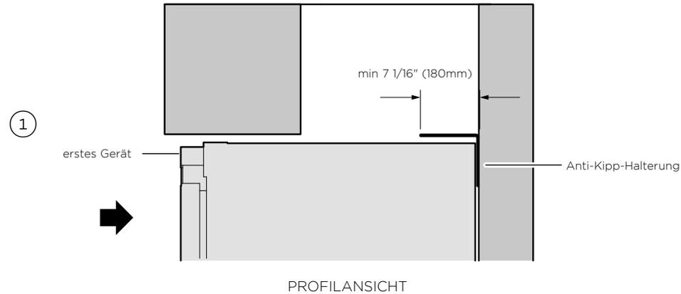
Rollen Sie das erste Gerät langsam in eine Seite des Schrank, bis die Kippschutzhalterung die Hinterkante des Geräts überlappt.
