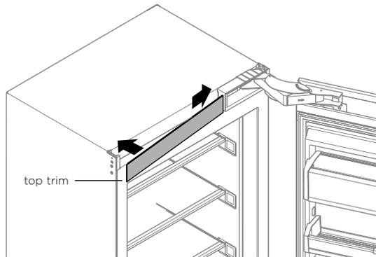
Schieben Sie ein Ende der oberen Verkleidung in die Scharnierabdeckung des Geräts
