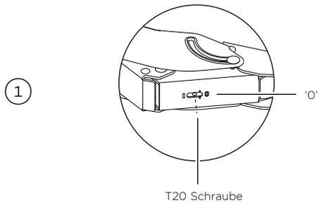
Lösen Sie die Scharnierfeder, indem Sie die T20-Schraube im Scharnier in die Position „0“ drehen.
