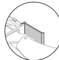
Stecken Sie die Seitenverkleidung hinter die obere Scharniertasche. Drücken Sie den Klebestreifen in den Hohlraum, um sicherzustellen, dass die Verkleidung auch fest an der Innenseite des Geräts anliegt. Schieben Sie auf der Seite ohne Scharnier die Seitenverkleidung hinter die obere Verkleidung.
