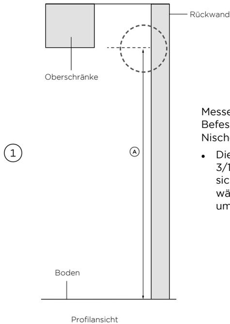
Messen Sie die Höhe (A) der Befestigungsstelle vom Boden bis zum Nischenrücklauf.
