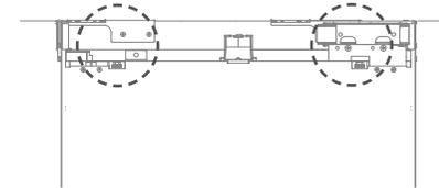
Befestigen Sie die linke und rechte obere Halterung mit 8Gx16-Senkschrauben an der Deckenfläche des Schrankes.
