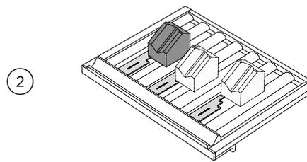
Setzen Sie die Schlittenführung auf die Lamellen hinter dem Griff. Richten Sie die Halterung am Abstandshalter nach Größe und Art der Weinflasche aus.
