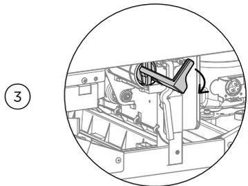
Drehen Sie den Filterkopf mit dem Filterwerkzeug um 90 ° im Uhrzeigersinn, um ihn zu arretieren.
